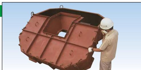
架台に法肩底板をはめ込み、中枠、法肩側板、側板を取り付け、最後に斜面板を取り付け組立完了 (打設～脱型はA形と同じ)
