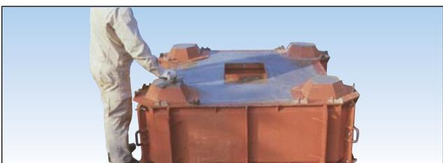
本均しをして打設完了、状況に応じた養生をします。
