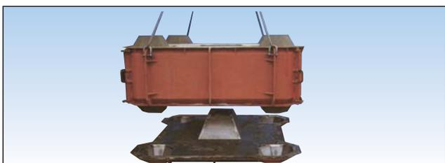
中枠をはずし、底板を残して側板ごと吊り上げます。
