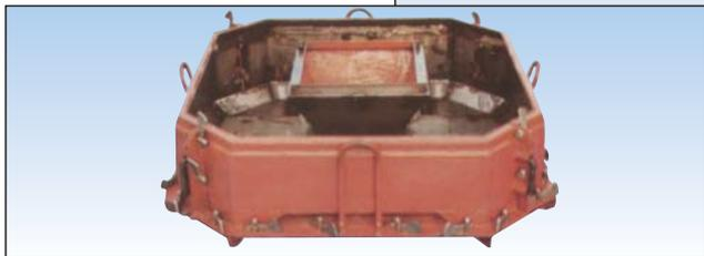
底板に側板と中枠をピン・矢で取り付け。
