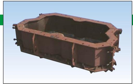
底板に側板(4枚)を取り付け、組立完了。 図-23
